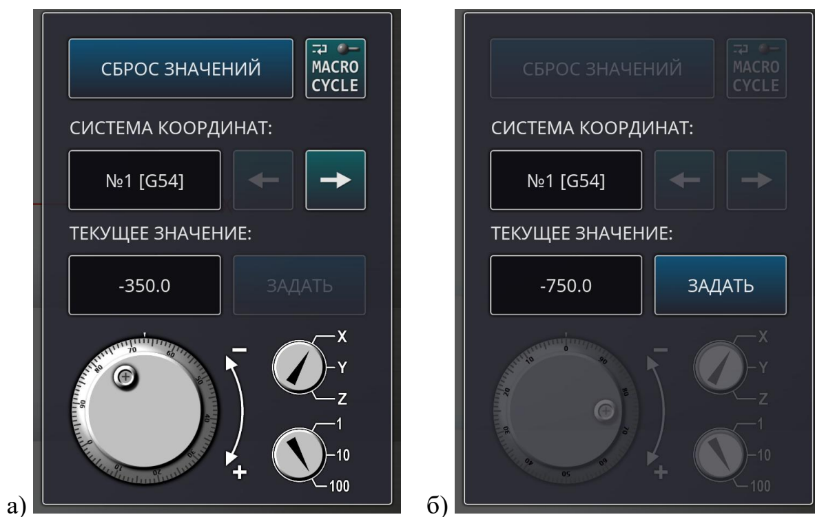
Рисунок 17 – Вид панели управления процессом привязки заготовки в режиме позиционирования щупа (а) и в режиме записи измеренного значения (б)
