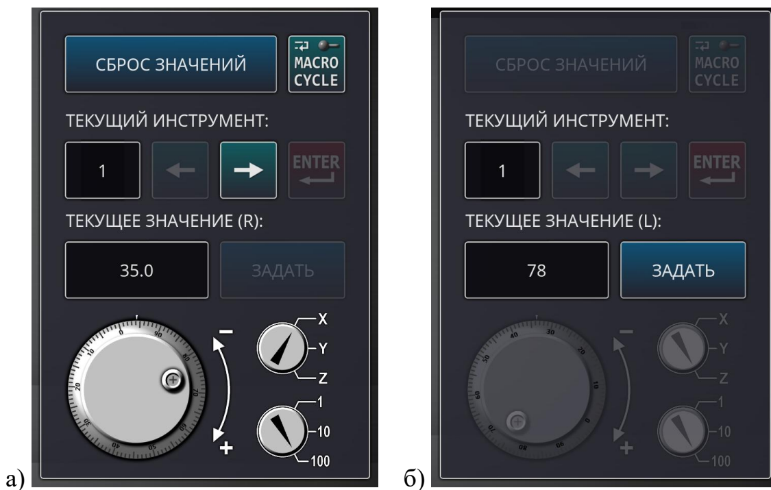
Рисунок 19 – Вид панели управления процессом привязки инструмента в режиме позиционирования (а) и в режиме записи измеренного значения (б)
