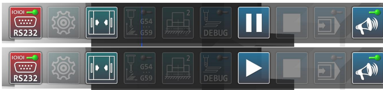
Рисунок 25 – Изображение кнопки «ПУСК»/«ПАУЗА» в программе-симуляторе в режиме автоматического управления на ЧПУ контроллере
