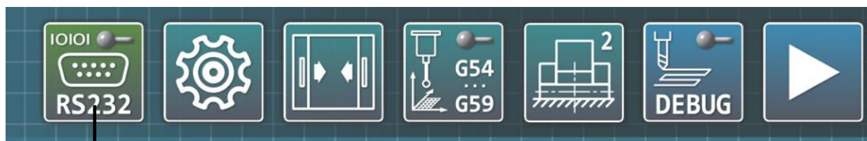
Кнопка включения/выключения режима аппаратного управления
