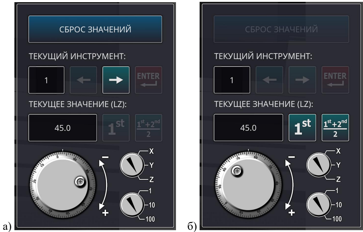
Рисунок 17 – Вид панели управления процессом привязки инструмента в режиме позиционирования (а) и в режиме записи измеренного значения (б)
